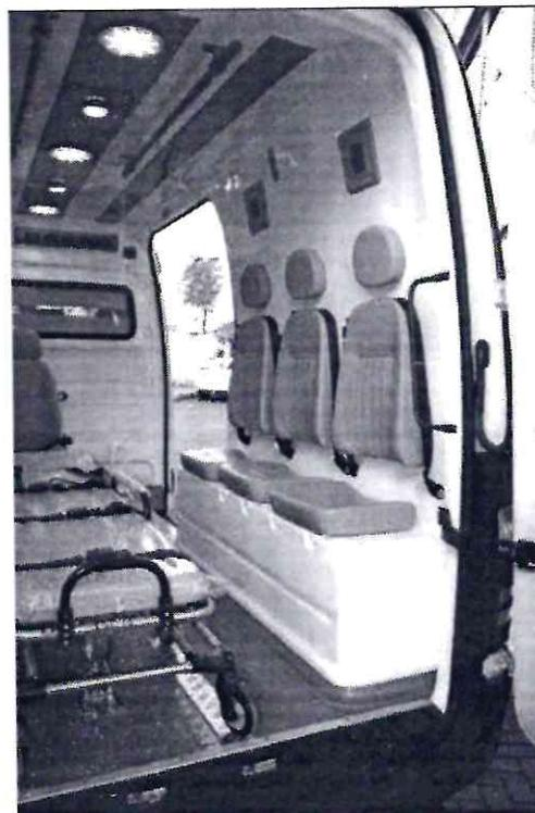
III – PEDE-SE: Maca retrátil em alumínio de 1,800 mm de comprimento.
